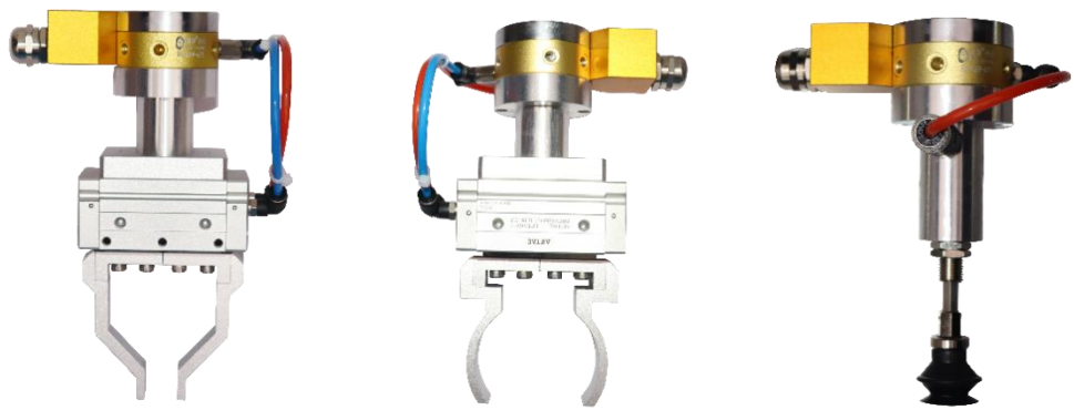
(1) 平口夹爪工具 (2) 弧口夹爪工具 (3) 吸盘工具 图 2 末端工具
